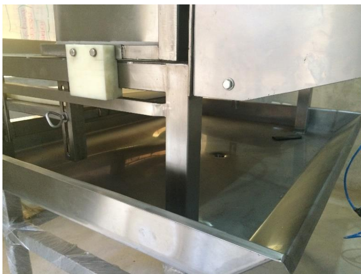
Figura 4.71 Bandeja recolectora terminada
