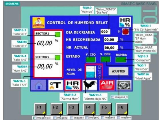
Figura 25.-Pantalla Sistema de Control de Humedad
