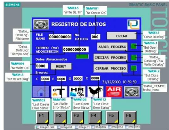
Figura 32.-Configuración de Data Logging
