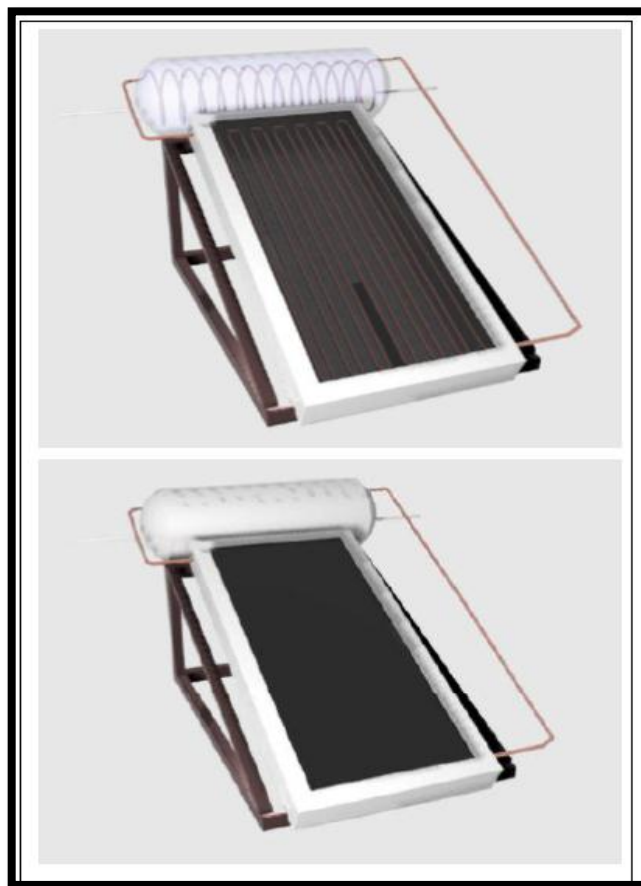
GRÁFICO Nro. 4.8. Vista del circuito cerrado de la tubería de cobre
