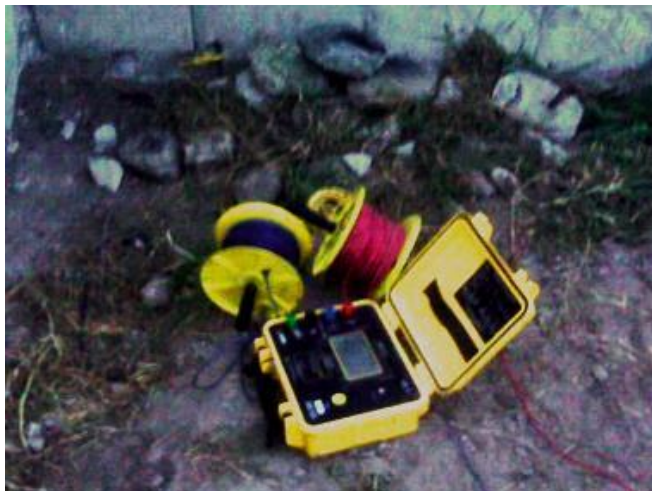
Figura 24: “Megger” Equipo de Medición de Resistividad de Tierra
