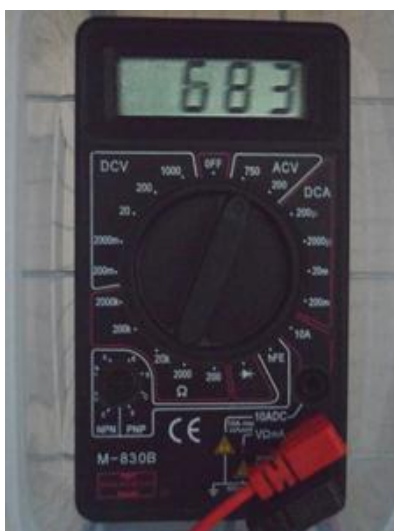
Figura 36. Marcación de Voltaje de Ruptura
