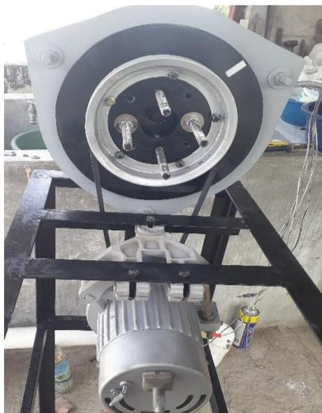
Fig. 3.1: Generador acoplado al motor
