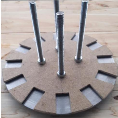
Fig. 2.22: Plantilla de posicionamiento acoplada al disco
