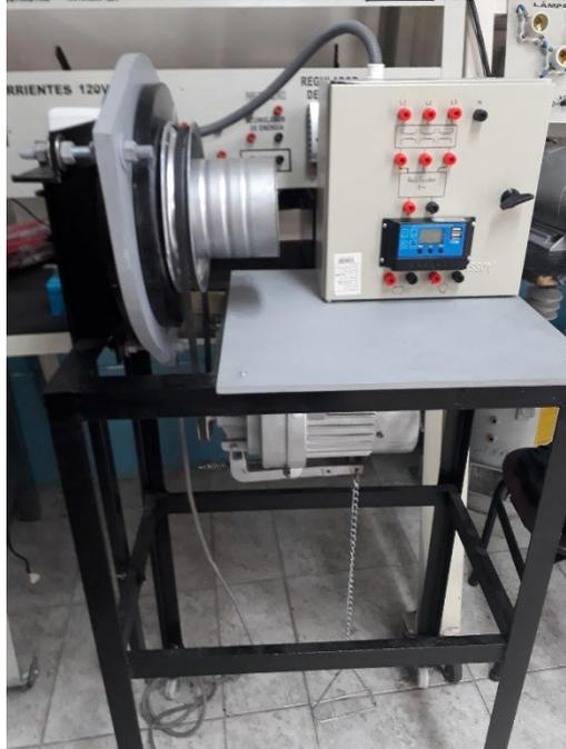
Fig. 1: Prototipo del sistema para microgeneración eólica
