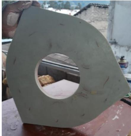
Fig. 2.17: Estator de generador fundido
