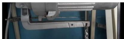
Fig. 5: Palanca de accionamiento del motor
