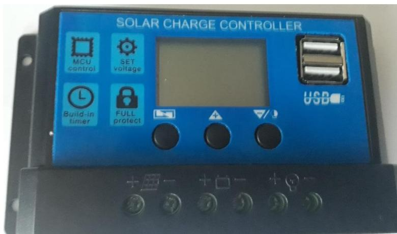
Fig. 2.30: Controlador de carga
