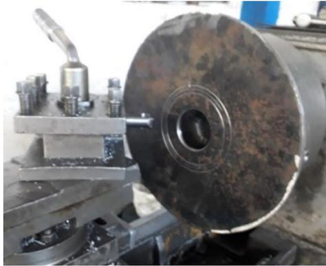
Fig. 2.19: Disco siendo mecanizado en el torno
