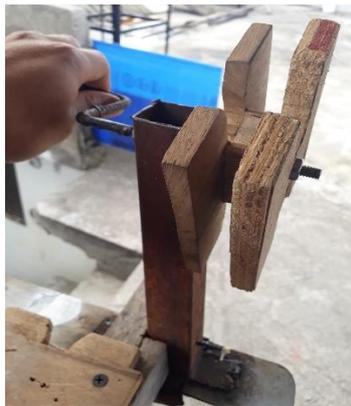
Fig. 2.12: Bobinadora manual
