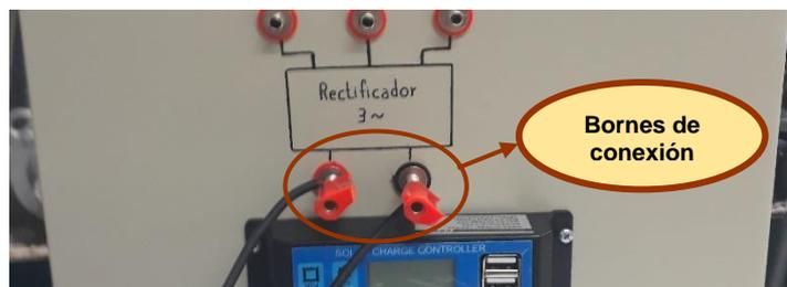
Fig. 1: Borne de conexión a la salida del rectificador trifásico
