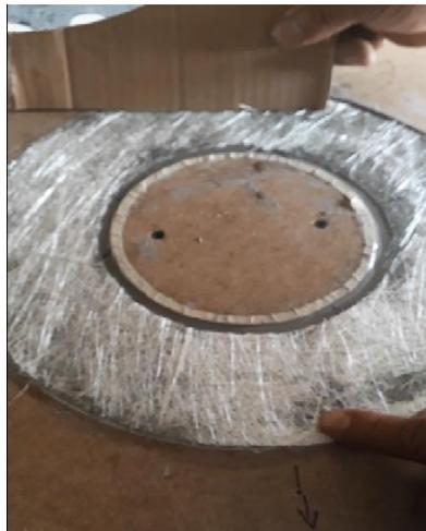
Fig. 2.25: Capa de fibra de vidrio colocada sobre los imanes
