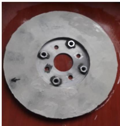
Fig. 2.26: Rotor magnético fundido
