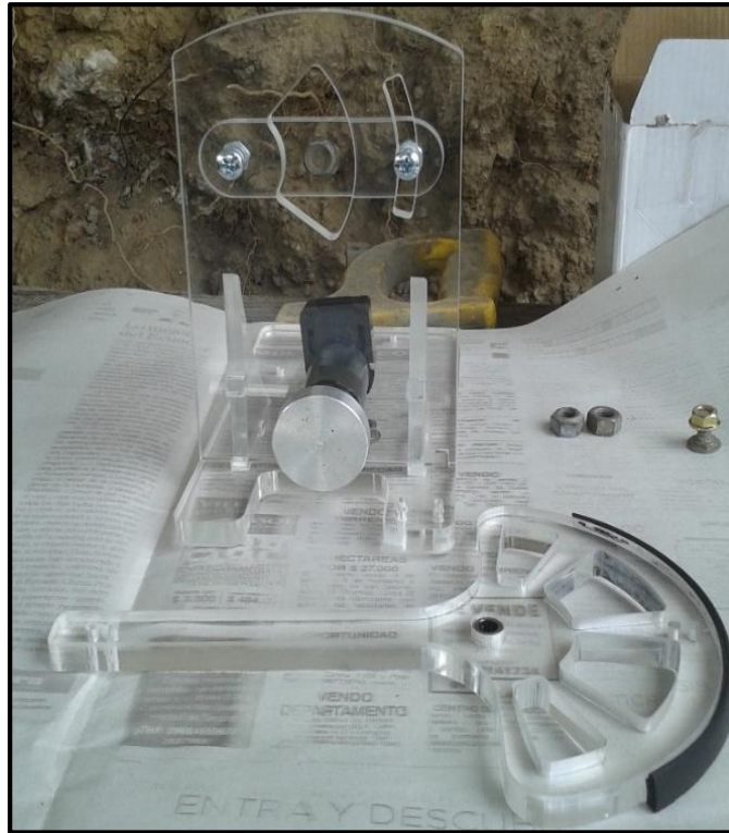
Figura 14: Estructura del módulo de paleta háptica en acrílico.
