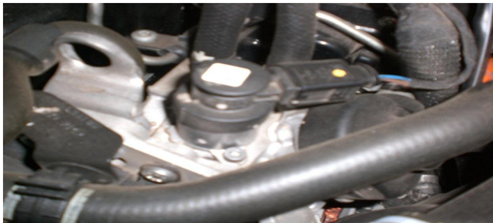
Gráfico 6.3. Válvula dosificadora de combustible. Fuente.(Autores).
