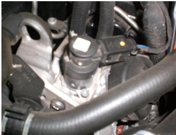
Gráfico 5.2. Válvula de control de admisión de combustible. Fuente. (Autores).
