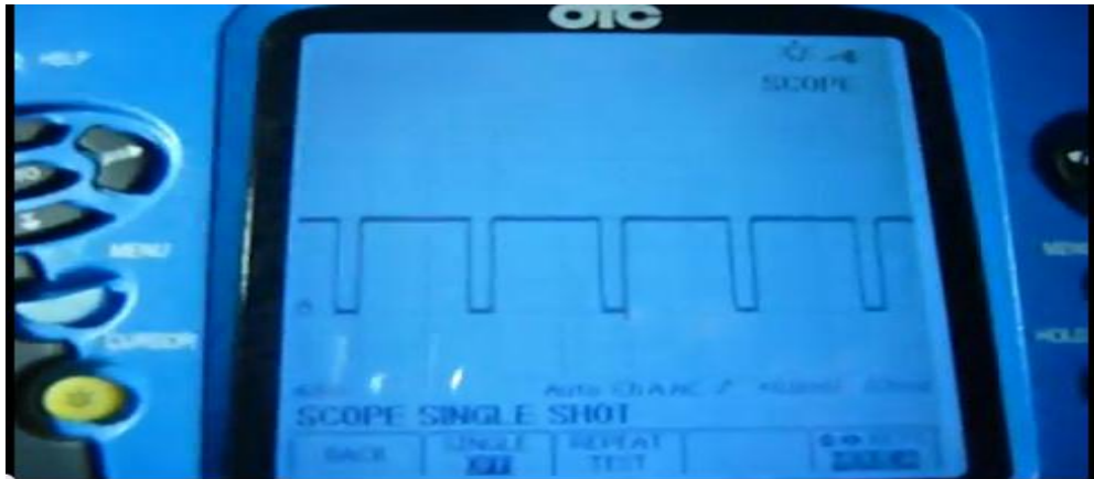
Figura 6.5 Señales PWM Fuente:(Autores).
