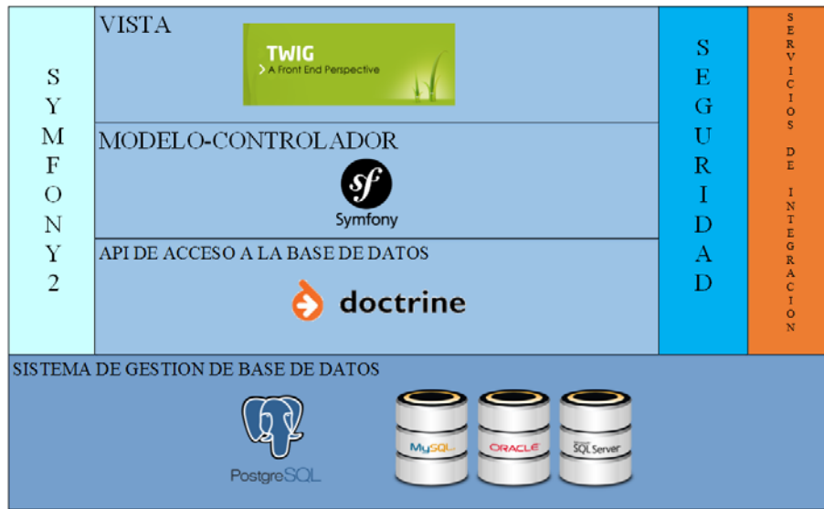
Figura 2: Arquitectura MVC de Symfony Fuente: Autoría Propia
