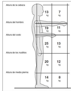
**Figura 2-2:** Peso teórico en función de la zona de manipulación.
