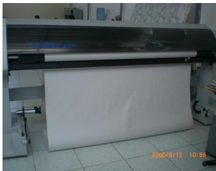
Máquina plotter para imprimir el diseño con medidas exactas
