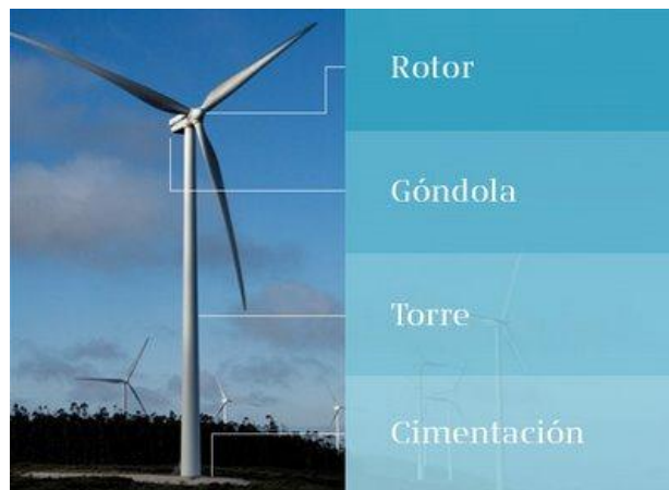
Gráfico N° 11 Aerogenerador de eje horizontal con los componentes de cimentación
