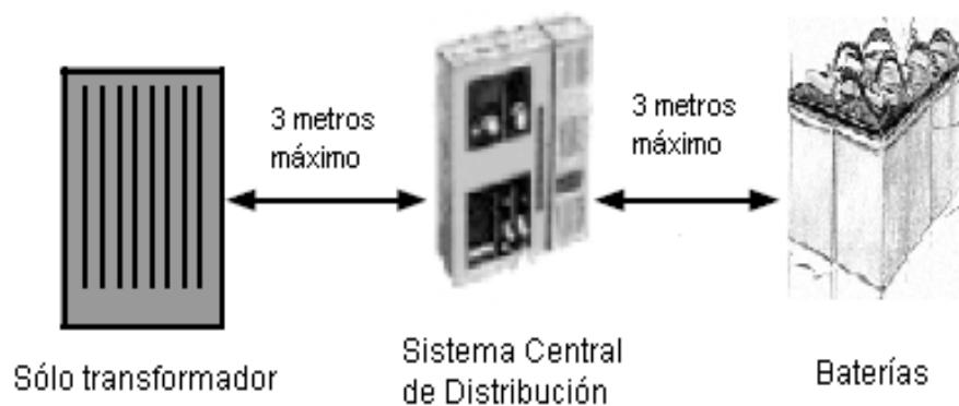
Gráfico N° 25 Instalación del SCD y el transformador
