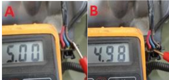
Figura 27. Voltaje de alimentación y señal del CMP Fuente: (Multímetro digital DT 832)
