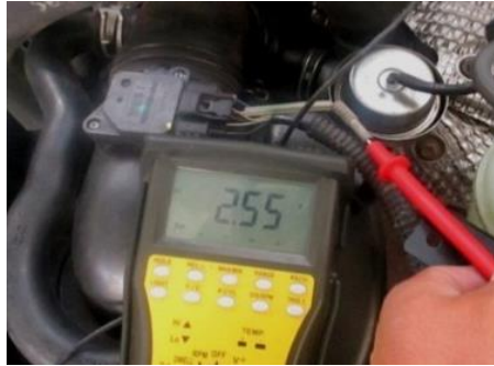
Figura 60. Voltaje de señal del MAF Fuente: (Multímetro TRISCO DA 830)
