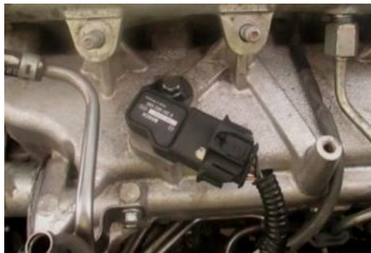
Figura 67.Ubicación del sensor MAP.
