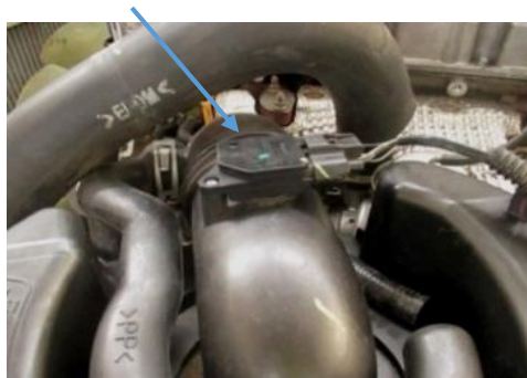
Figura 56.Ubicación sensor MAF
