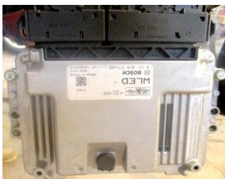
Figura 10. Unidad electrónica de Control
