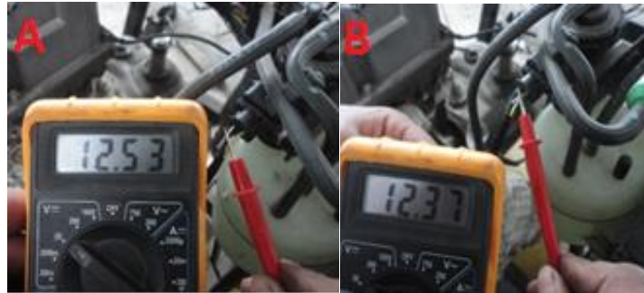
Figura 93. Voltajes de alimentación y señal actuadora de la válvula de vacío Fuente: (Multímetro digital DT 832)
