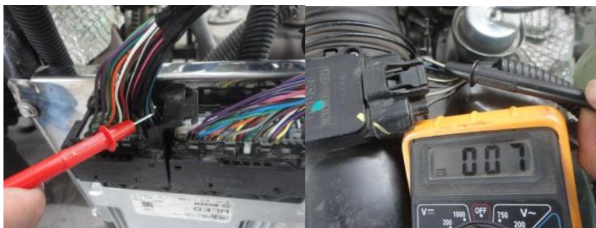
Figura 102. Medición de continuidad
