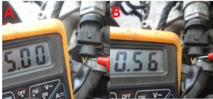
Figura 43. Voltajes de alimentación y señal del FRP Fuente: (Multímetro digital DT 832)
