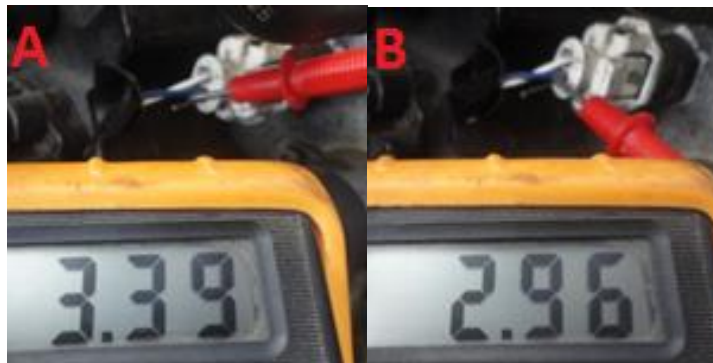
Figura 77.Voltaje de señal del sensor EFT Fuente: (Multímetro digital DT 832)
