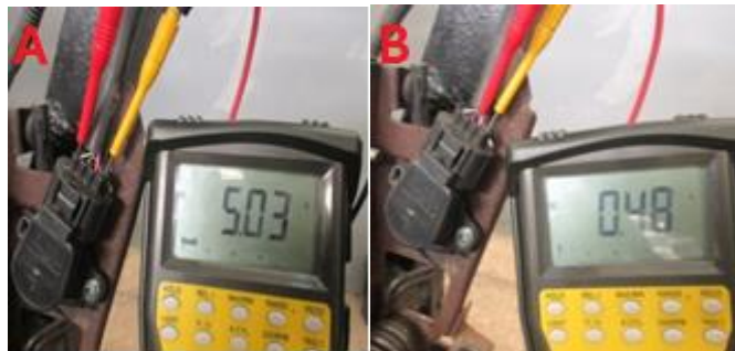
Figura 35. Voltajes de alimentación y señal del APP Fuente: (Multímetro TRISCO DA 830)
