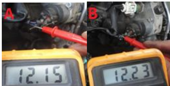
Figura 87. Voltajes de la válvula de presión Fuente: (Multímetro digital DT 832)
