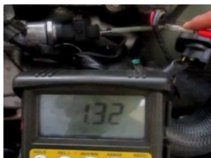
Figura 44. Voltaje de señal del FRP Fuente: (Multímetro TRISCO DA 830)
