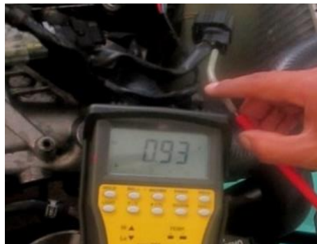
Figura 52. Voltaje de señal del ECT Fuente: (Multímetro) TRISCO DA 830)
