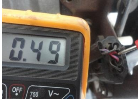
Figura 36. Voltaje de señal del APP Fuente: (Multímetro digital DT 832)
