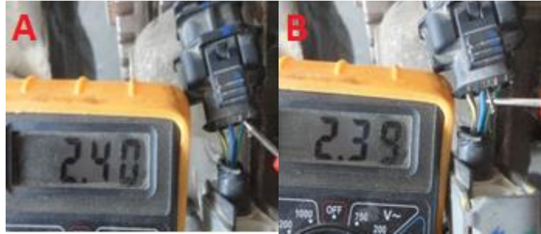
Figura 19. Voltaje de alimentación y señal del CKP Fuente: (Multímetro digital DT 832)
