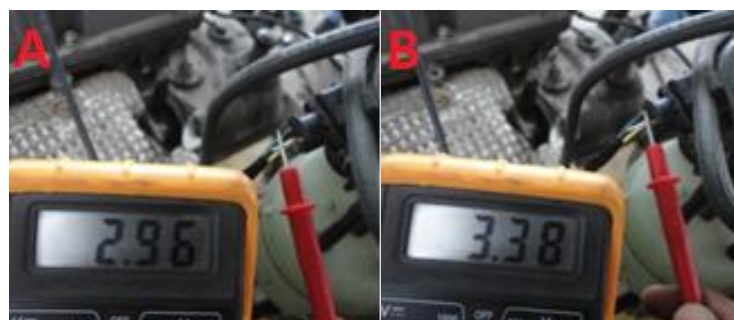
Figura 94. Voltajes de señal actuadora de la válvula de vacío Fuente: (Multímetro digital DT 832)
