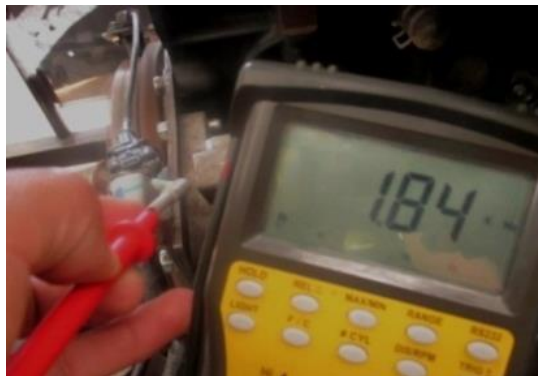
Figura 20. Señal de frecuencia del CKP Fuente: (Multímetro TRISCO DA 830)
