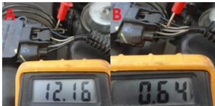
Figura 59. Voltaje de alimentación y señal del MAF Fuente: (Multímetro digital DT 832)
