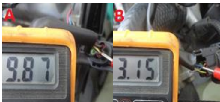
Figura 51. Voltaje de alimentación y señal del ECT Fuente: (Multímetro digital DT 830)
