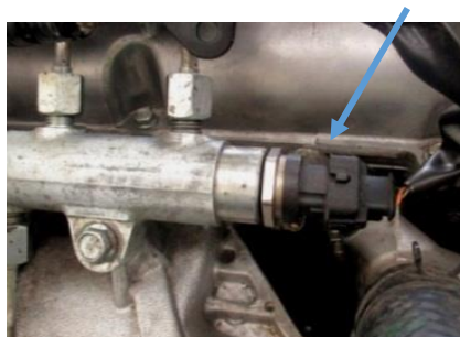
Figura 40. Ubicación sensor presión de rail
