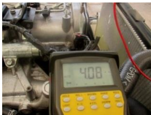
Figura 28. Señal de frecuencia del CMP Fuente: (Multímetro TRISCO DA 830)
