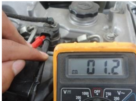
Figura 83. Resistencia del inyector Fuente: (Multímetro digital DT 832)
