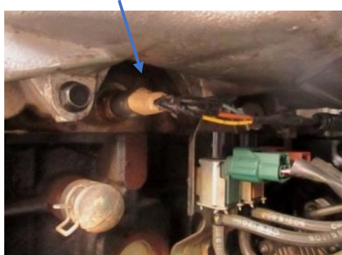
Figura 48. Ubicación del sensor de temperatura.
