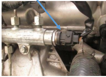
Figura 5. Ubicación del sensor FRT.
