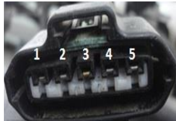
Figura 4. Socket del MAF
