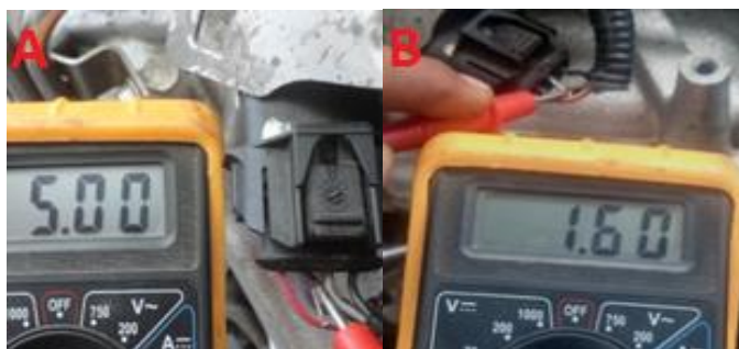
Figura 70. Voltajes de alimentación y señal del MAP Fuente: (Multímetro digital DT 832)
