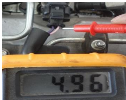
Figura 82. Voltaje del inyector Fuente: (Multímetro digital DT 832)
