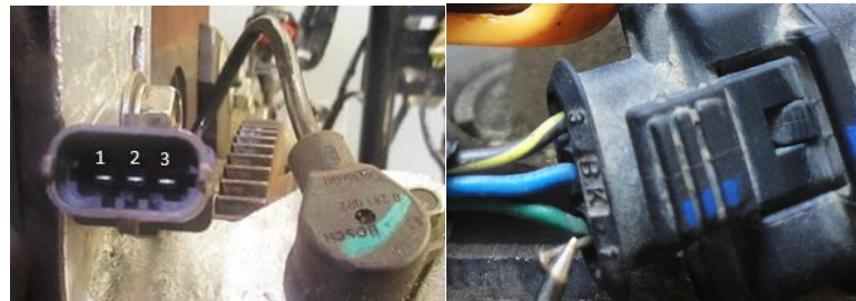
Figura 17. Vista del sensor y conector del CKP
