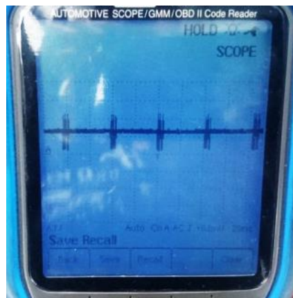
Figura 46. Gráfica del sensor presión de rail Fuente: (Osciloscopio OTC)
