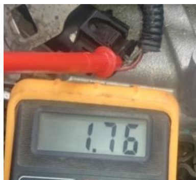
Figura 71. Voltaje de señal del MAP Fuente: (Multímetro digital DT 832)
