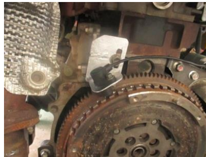
Figura 3. Ubicación del sensor CKP.
