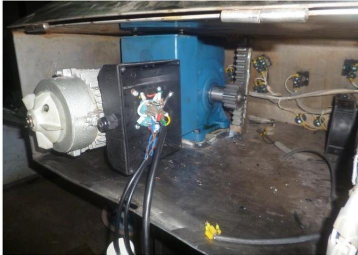
**Figura 4. 17** Montaje del motorreductor, piñón y cremallera
