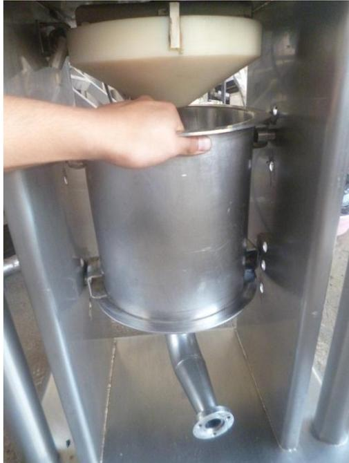
**Figura 4. 19** Montaje del recipiente contenedor
