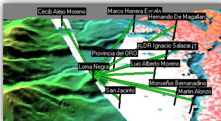
Figura 45: Área de Cobertura de la Antena sectoriales a 120^\circ y la Antena Directiva en el Repetidor de Loma Negra; simulación realizada en el software Radio Mobile.
