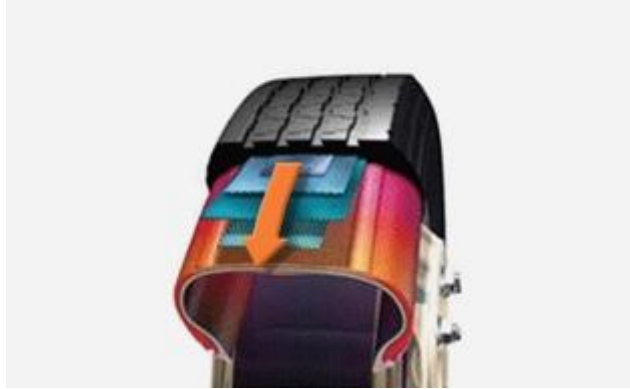
Figura 2.6 Estructura de un neumático radial (Hankooktire, 2014, pág. 30)
