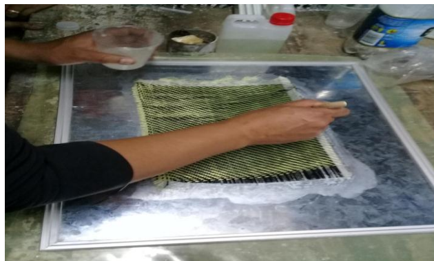
Figura 4.26 Impregnación del tejido y la mezcla.
