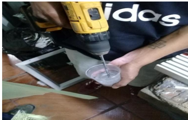
Figura 4.24 Mezcla entre la resina y el endurecedor.
