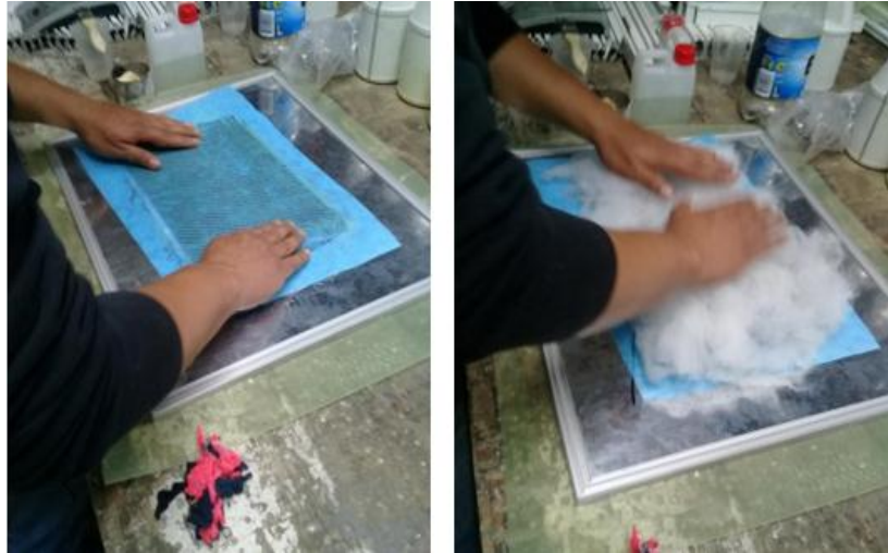
Figura 4.27 Proceso de vacío.
