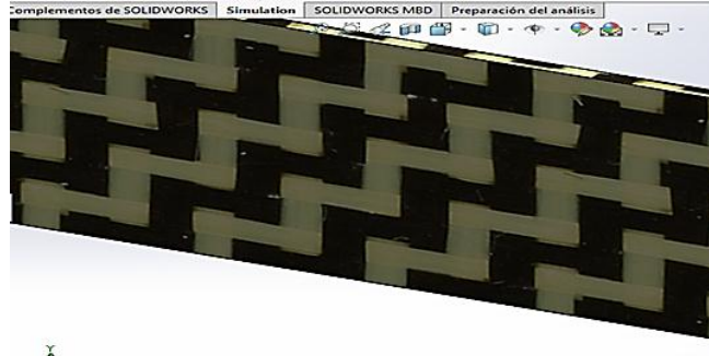
Figura 4.39 Asignación de la fibra de carbono y sus capas.
