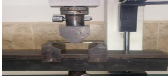
Figura 4.36 Desarrollo del ensayo a flexión.
