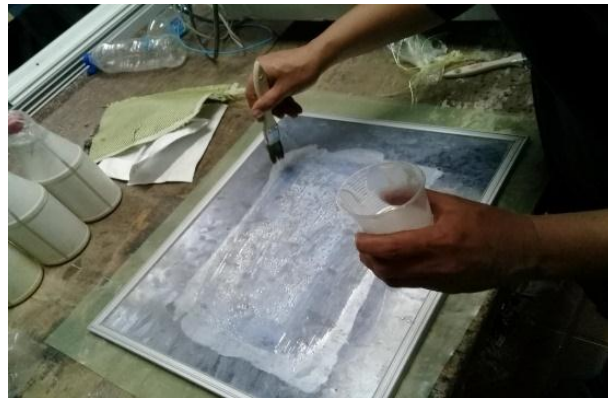
Figura 4.25 Mezcla en la superficie del molde.
