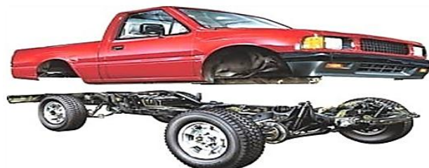
Figura 2.20 Tipos de carrocería y chasis Fuente: (Rodríguez H. , 2018) , pág. 60
