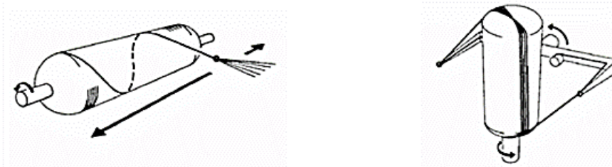
Figura 2.13 Procedimiento de conformado por enrollamiento.
