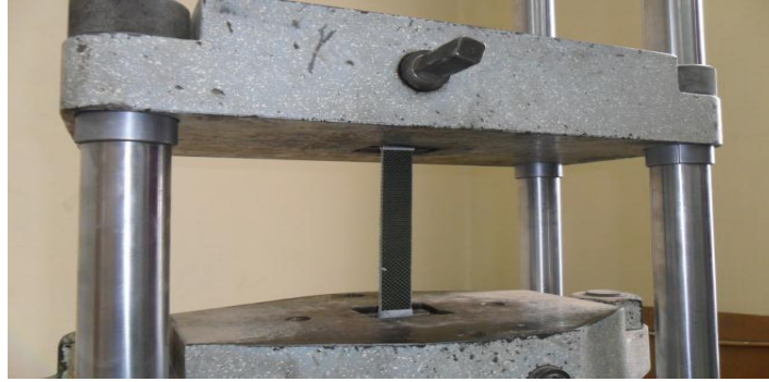
Figura 4.31 Probeta (FC Unidireccional) sometida a ensayos de tracción.
