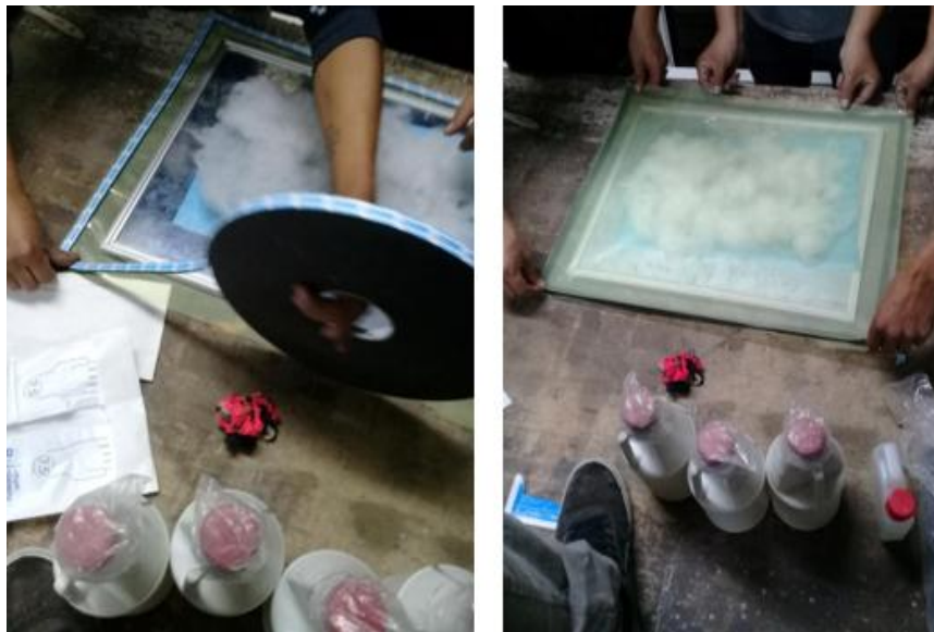
Figura 4.28 Proceso de vacío empacado.
