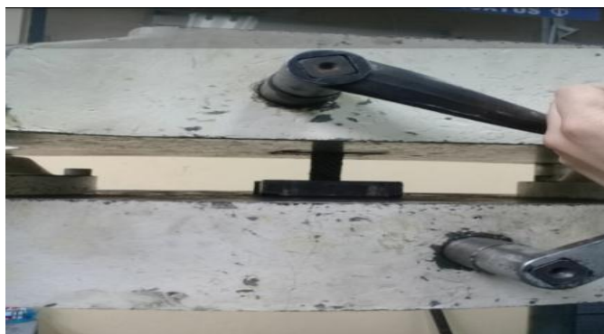
Figura 4.30 Probeta (FC Bidireccional) sometida a ensayos de tracción
