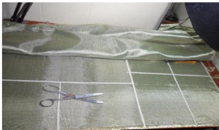
Figura 4.21 Colocación de la cinta adhesiva.
