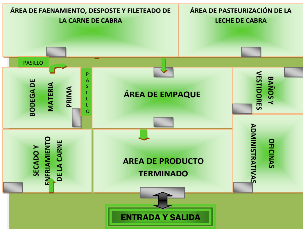
ILUSTRACIÓN No. 10 DISEÑO DE LA PLANTA
