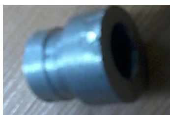
Figura 3.42: Mecanizado de la parte interna de la culata posterior en el torno
