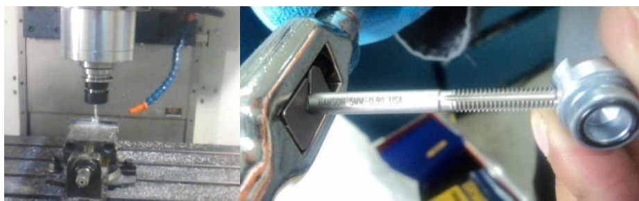
Figura 3.43: Elaboración de agujeros para el ingreso de racores en las culatas
