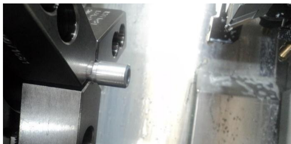
Figura 3.40: Mecanizado de la parte delantera de la culata anterior en el torno
