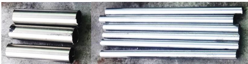
Figura 3.23: Tronzado de material para vástagos y camisas
