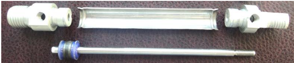
Figura 3.3: Proceso de ingeniería inversa de un cilindro neumático
