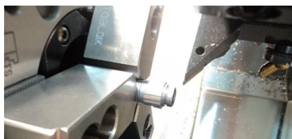
Figura 3.41: Mecanizado de la parte externa de la culata posterior en el torno
