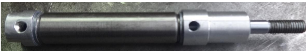
3.45: Ensamblaje general del cilindro neumático
