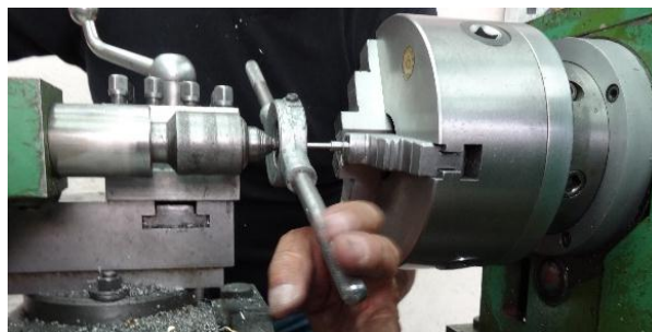
Figura 3.38: Roscado de la parte posterior del vástago con tarraja
