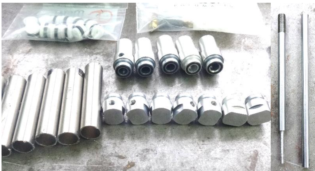
Figura 3.44: Piezas para el ensamblaje de cilindros
