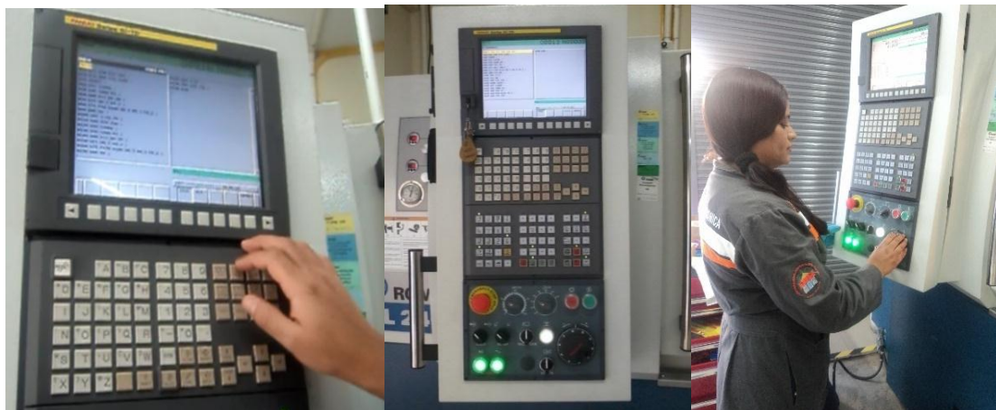
Figura 3.22: Ingreso del código G en la pantalla de programación del Torno
