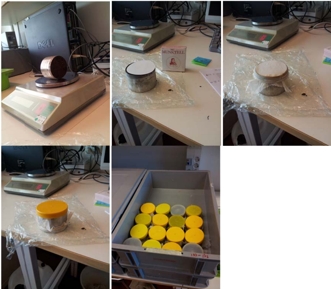
Figur 10. Visar samtliga steg vid vägning och iordningställning inför blötläggning. Från vänster till höger uppifrån och ned: steg 1 vägning av provet, steg 2 filter, steg 3 duk och gummiband, steg 4 lock för förhindrad avdunstning, steg 5 blötläggning i balja.
