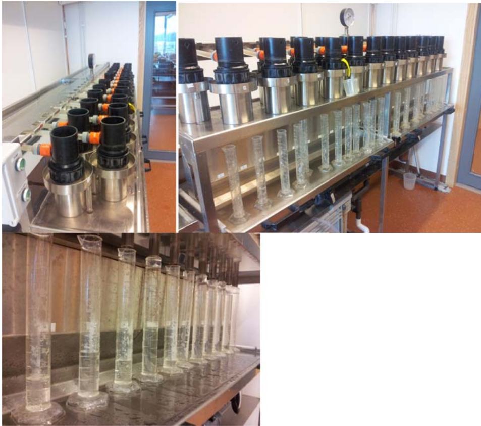
Figur 12. De översta bilderna visar apparaten färdigmonterad för infiltrationsmätning och den undre bilden visar hur mätglasen var placerade för att uppmäta mängden infiltrerat vatten under den specifika tiden.
