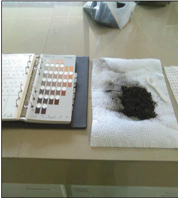
Ilustración 5. Determinación del color del suelo. Fuente: David Cáceres
