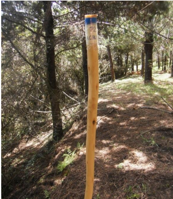
Ilustración 1. Señalamiento con el Jalón Fuente: David Cáceres
