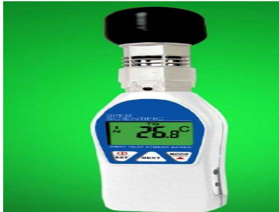
**Gráfico 3.2.2:1 MEDIDOR DE ESTRÉS TÉRMICO (SPER SCIENTIFIC 800036)**
