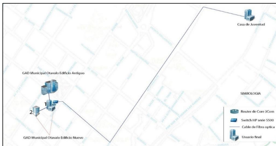
FIGURA 3. 9: Topología física de la red de fibra óptica actual.
