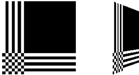
Ilustración 134: Modo de envoltura GL_CLAMP [OPEN07]
