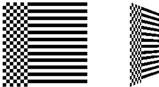
Ilustración 135: Modo de envoltura GL_REPEAT y GL_CLAMP combinados [OPEN07]
