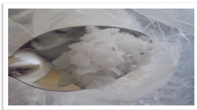
Figura 8. Hidróxido de sodio
