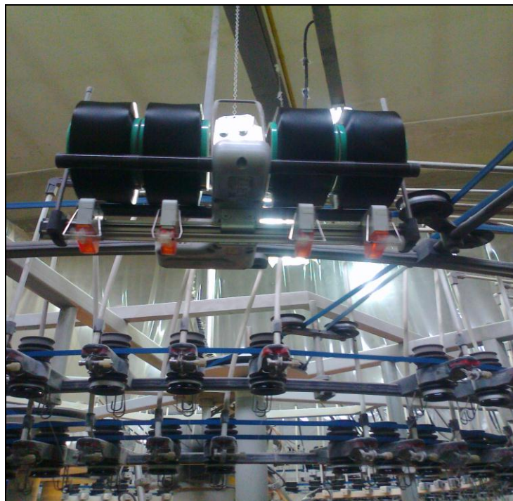
Fig. 13.- Fileta de alimentación de elastano
