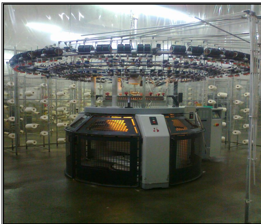
Fig. 12.- Máquina circular de tejido de punto (Mayer)
