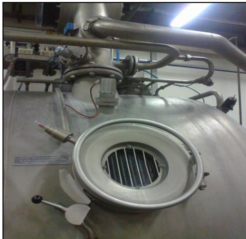
Fig. 21 Escotilla de la máquina de tintura (eco – soft plus 140)
