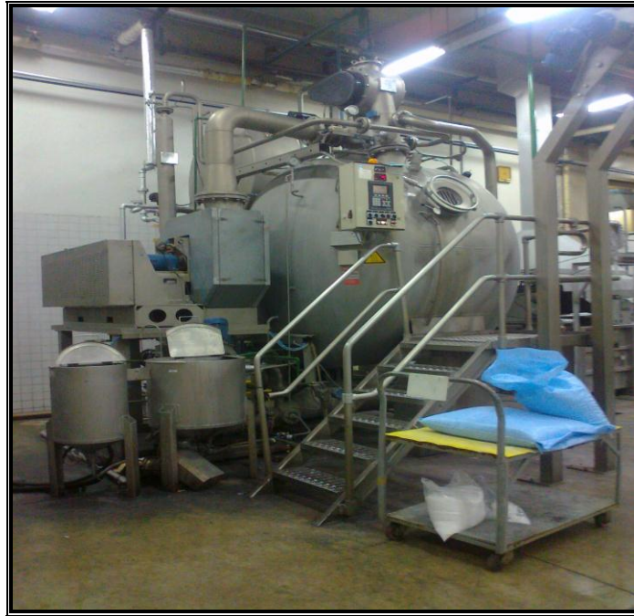
Fig. 19.- Máquina de tintura (eco – soft plus 140)
