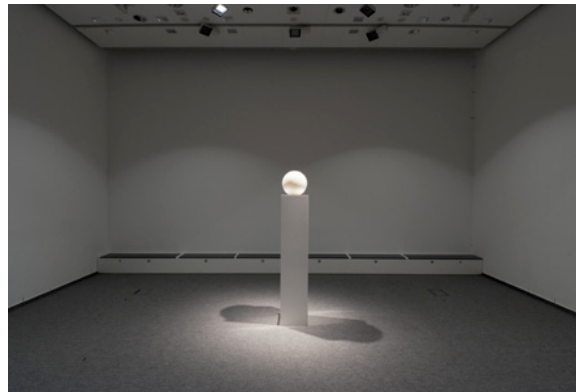
L2 Horizontale Allgemeinbeleuchtung und Akzentbeleuchtung
