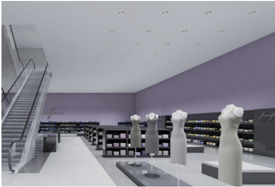
L1 Horizontale Allgemeinbeleuchtung mit runden Deckeneinbauleuchten
