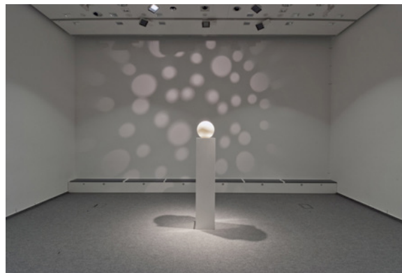
L14 Horizontale Allgemeinbeleuchtung, Akzentbeleuchtung und Projektion
