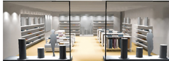
L2b Horizontale Allgemeinbeleuchtung mit Aufhellung der Wände und Akzentbeleuchtung
