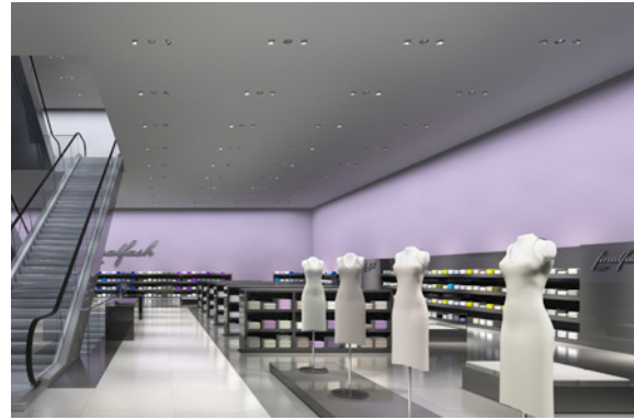
L2 Horizontale Allgemeinbeleuchtung, Akzentbeleuchtung und Wandflutung
