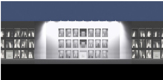
L3 Seitengebäude unbeleuchtet. Mittelgebäude Flutung, Gruppe 1
