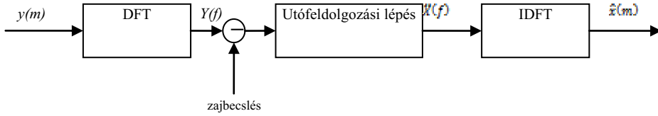
3. ábra. A spectral subtraction eljárás blokkdiagramja.
