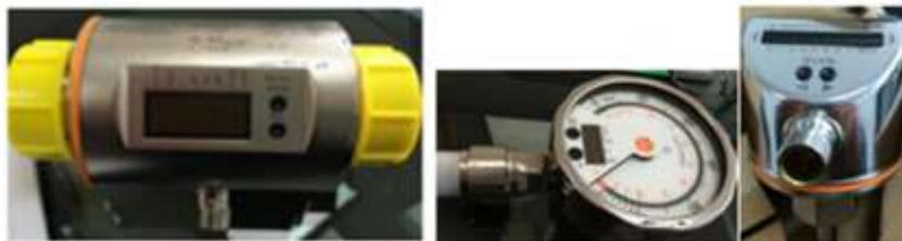
Fig. 7: Sensor de caudal, presión y flujo respectivamente
