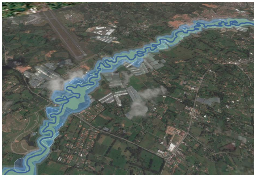
Ilustración 4. Caudales máximos para el río Negro en el periodo de retorno de los 100 años. Fuente: elaboración propia con base a Findeter (2016).
