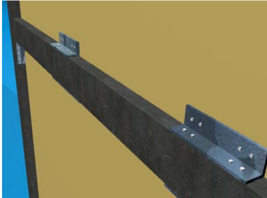
Detalle ensamble paneles tetrapak
