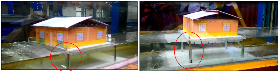
Figura 56. Momento de flotación del modelo Fuente: propia
