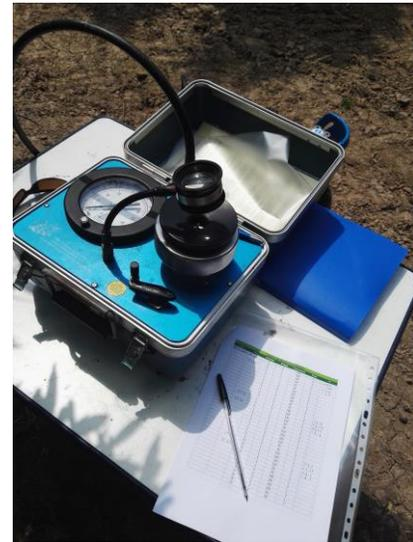
Figura 2. Cámara de presión tipo Scholander usada para la toma de medidas de potencial
