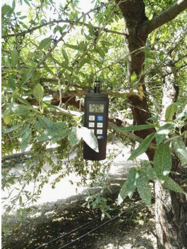
Figura 3. Localización de un termo higrómetro portátil usado durante momento de la toma de datos de potencial.
