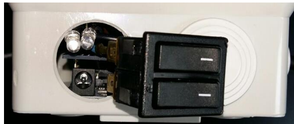
Detalle del interruptor, los LEDs y la clavija de alimentación.
