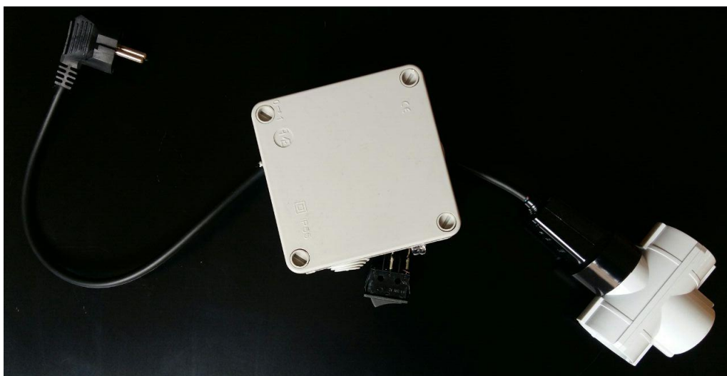
Aspecto final del dispositivo implementado para la medida de la demanda del PC.
