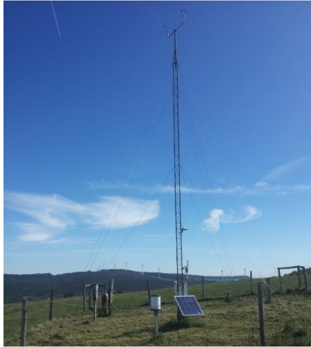
Figura 3.10. Estación meteorológica automática de Marco da Curra. [34]
