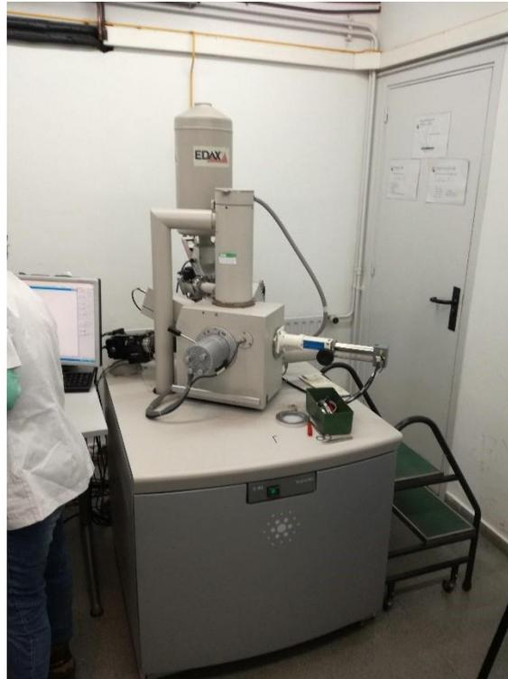
*Ilustración 18 - Microscopio Electrónico*
