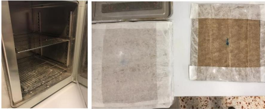
*Ilustración 7 – Preparación de la fibra para el Horno.*
