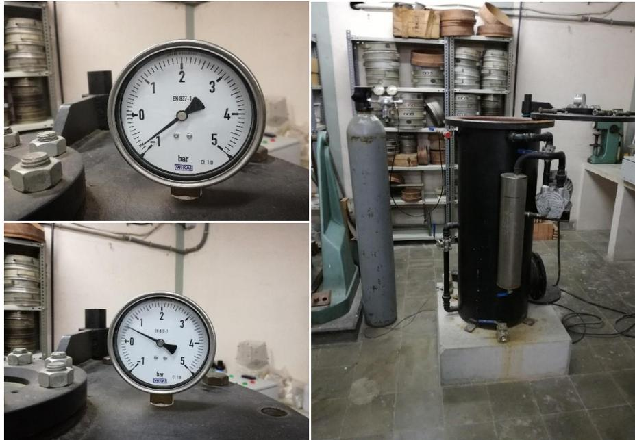
*Ilustración 15 - Autoclave para carbonatación acelerada.*
