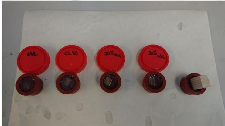
*Ilustración 19 - Muestras en Resina Epoxi.*
