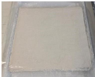
*Ilustración 12 - Probeta colocada sobre el molde de metacrilato.*
