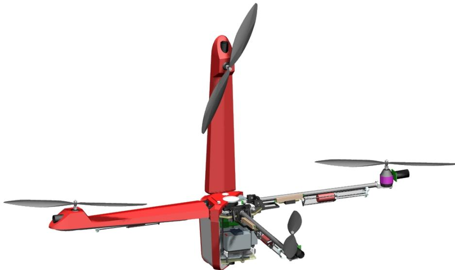
Figure 16: Représentation 3D du drone Alcedo[14].
