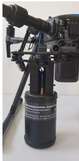
(a) Port 2 de la double gimbal avec adaptateur et antenne
