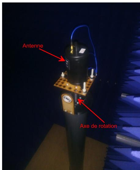
Figure 18: Chambre anéchoïque avec plateau tournant pour mesures de l'antenne
