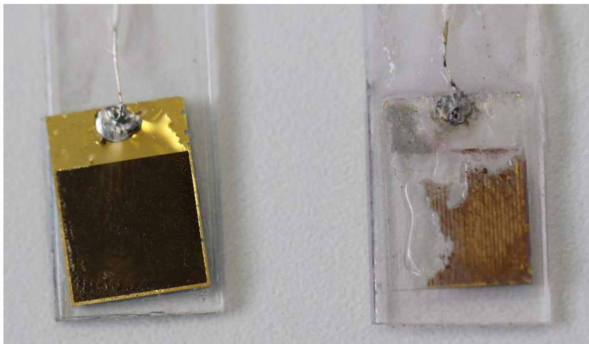
Figure 11 : Premières tentatives d'électrodes d'or. A gauche l'électrode avant implémentation dans un réacteur, à droite après implémentation. Le dépôt est rongé.
