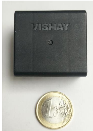
Figura 5.16 – Condensador MKP1848 DCL da VISHAY utilizado no filtro passivo do tipo LC.
