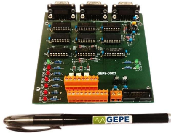
Figura 5.29 – Placa de comando trifásica.
