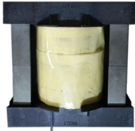
Figura 5.6 – Transformador de alta-frequência desenvolvido.
