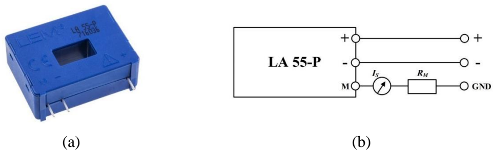
Figura 5.23 – Sensor de corrente LA 50-P do fabricante LEM : (a) Aspeto do sensor; (b) Esquema de ligação do sensor de corrente LA 50-P [92].
