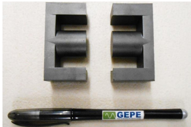
Figura 5.4 – Núcleo de ferrite B66397G0000X187 do fabricante Epcos .
