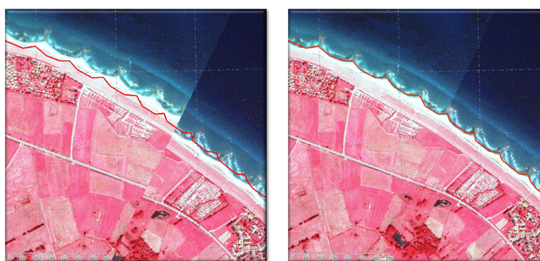
Abb. 2: Ergebnis von RST (links) und direkter (rechts) Georeferenzierung (OSM Küstenlinie: rot)
