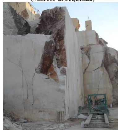
Figura 19 - Taglio della bancata in fette e taglio di una fetta in blocchi: esempio di lavorazioni in serie (vincolo di sequenza)
