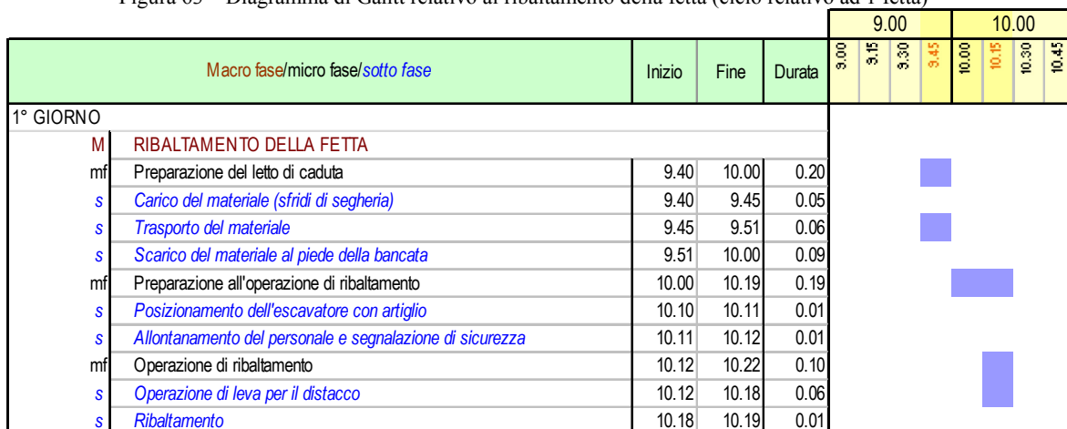
Figura 63 – Diagramma di Gantt relativo al ribaltamento della fetta (ciclo relativo ad 1 fetta)
