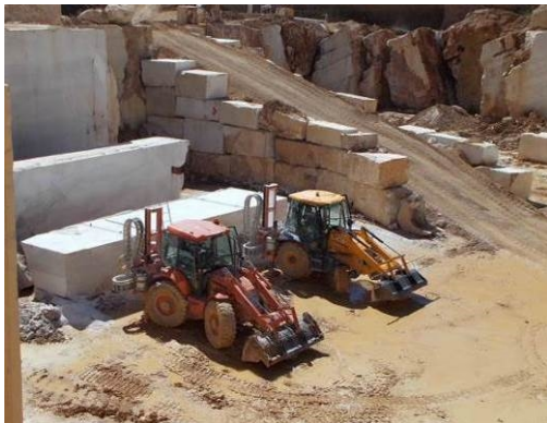
Figura 18 - Taglio della fetta in blocchi: esempio di lavorazioni in parallelo
