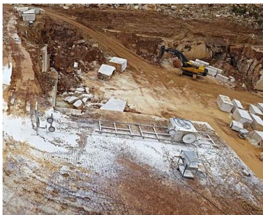
Figura 20 - Taglio di isolamento della bancata: taglio verticale tramite filo diamantato (a) e taglio orizzontale tramite segatrice a catena (b). Esempio di lavorazioni in serie (vincolo di sequenza)
