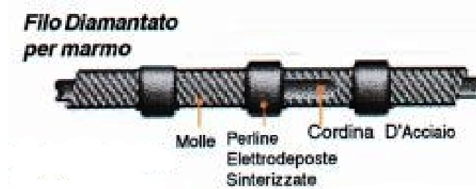
Figura 46 – Filo diamantato per marmo (Testa M., 2002)
