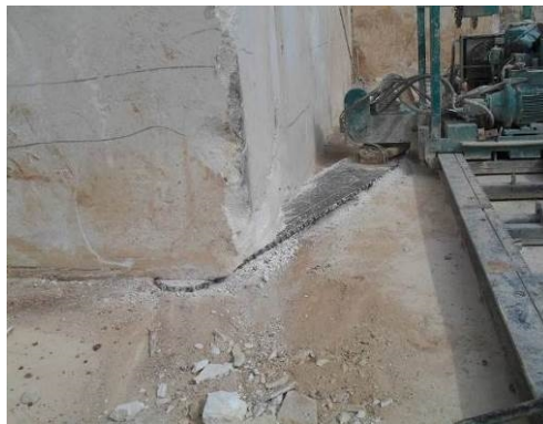
Figura 37 – La segatrice a catena durante le fasi iniziali del taglio
