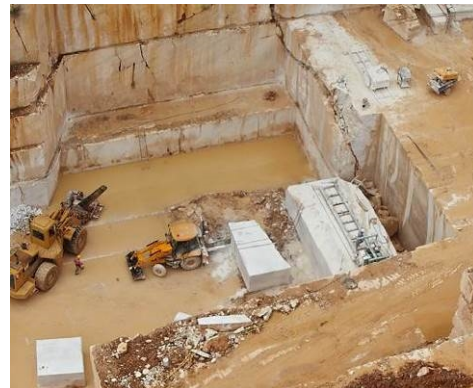
Figura 19 - Taglio della bancata in fette e taglio di una fetta in blocchi: esempio di lavorazioni in serie (vincolo di sequenza)
