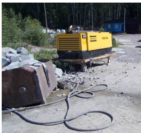
Figura 52 – Compressore e tubazione di collegamento alle utenze
