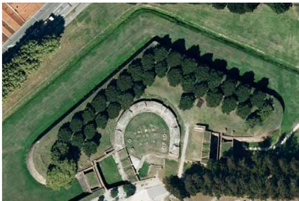
Figura 27: Foto aerea del baluardo di San Martino (fonte: http://maps.google.it ) parte del sistema difensivo alla moderna , che ripropone la traccia del torrione di inizio Cinquecento. La torre viene inglobata con funzione di cavaliere sulla scia delle soluzioni adottate dal Sangallo il Giovane per le fortezze di Livorno, Poggio Imperiale e Firenze.
