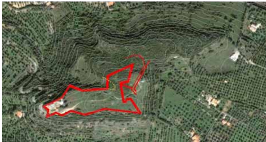
Figura 38: inserimento del disegno di progetto su foto aerea attuale (fonte: http://maps.google.it ) con curve di livello e ipotesi di scala metrica con canne da 12 palmi di 22,34 cm, nella quale si ‘legge’ facilmente la fossa (linea puntinata).
