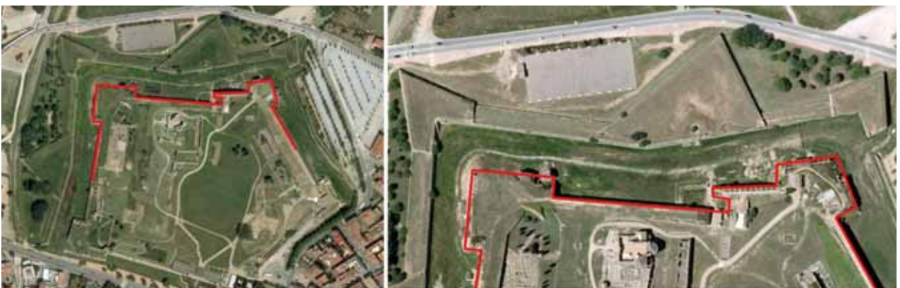
Figura 14: Cortina ripiegata nel progetto del 1552 per Rosas in Spagna ad opera dell'ingegnere Giovan Battista Calvi, con una soluzione più tardi proposta nel trattato del Maggi e Castriotto (elaborazione su immagine aerea, fonte: http://maps.google.it ).
