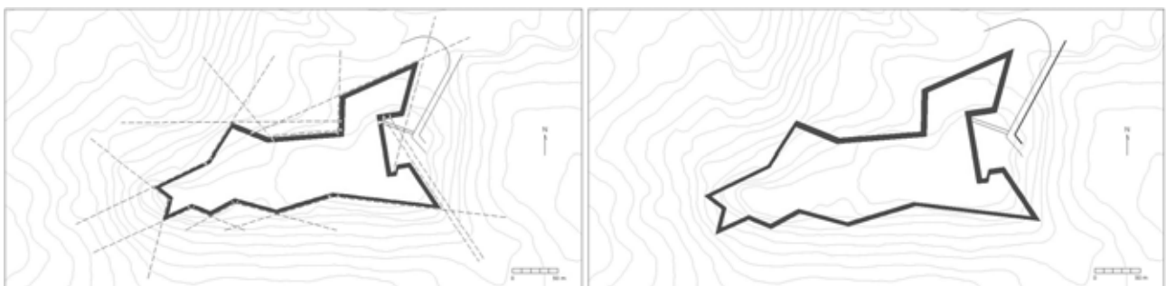
Figura 39: a sinistra la copertura offerta dall'artiglieria (digitalizzazione del progetto ed inserimento su planimetria a curve di livello con equidistanza pari a 4 m) nell'ipotesi di utilizzo di scala metrica costituita da palmi da 22,34 cm ed a destra l'inserimento del disegno di progetto (su planimetria a curve di livello con equidistanza pari a 4 metri) con l'utilizzo di una scala metrica costituita da palmi da 26,2 cm.
