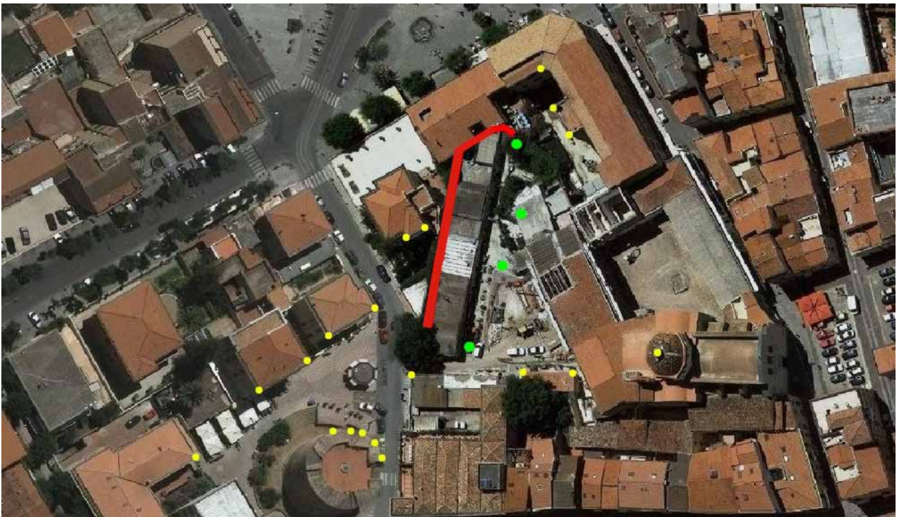
Figura 77: inserimento della traccia della cortina su foto aerea (fonte: www.sardegna territorio.it/webgis/fotoaeree ) con indicazione delle stazioni di rilievo (colore verde) e dei punti utili all'inserimento del tratto di cortina nel contesto.
