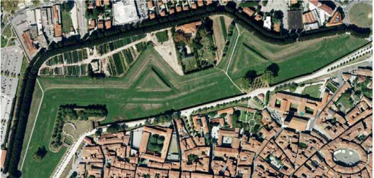
Figura 39: opere esterne (rivellini ) e da sinistra verso destra il baluardo di Santa Croce ed il baluardo di San Frediano (fonte: http://maps.google.it ).
