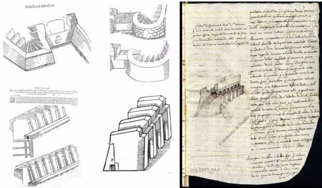
Figura 59: schemi grafici proposti nel trattato del Maggi e Castriotto ed un documento di Tiburzio Spannocchi conservato presso l'Archivio di Simancas in Spagna ( Perfil de la cortina de la muralla de la ciudadela de Pamplona , 30x22, SGU/-03352-32).
