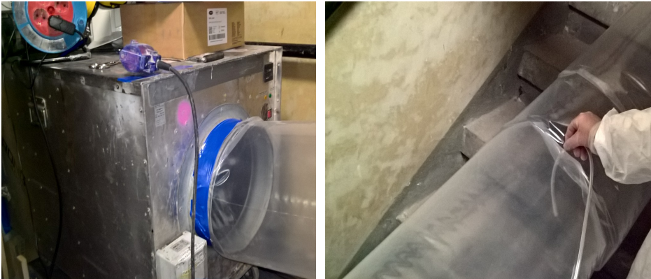
Kuva 6. Hiukkaspitoisuuden mittaus alipaineistajan ulospuhallusilmasta.
