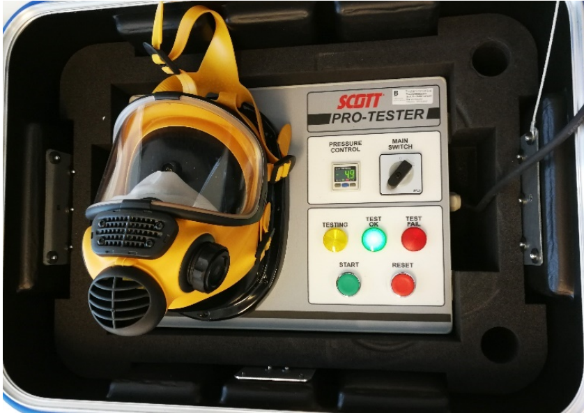
Kuva 14. Naamarin eheyden mittaus alipaineella.
