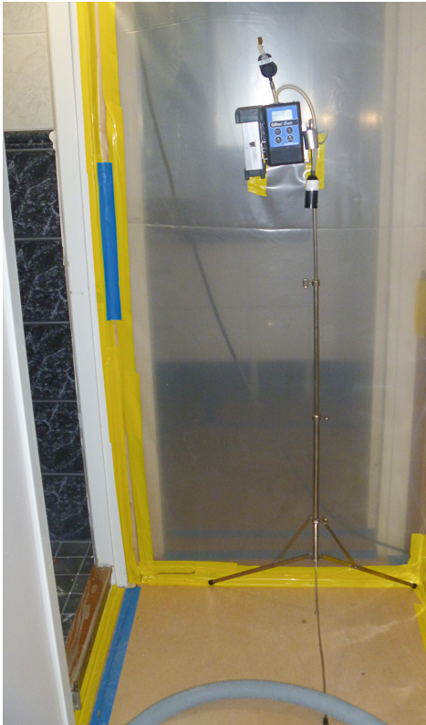
Kuva 4. Mittauspiste osastoinnin sisällä kylpyhuoneen edessä.
