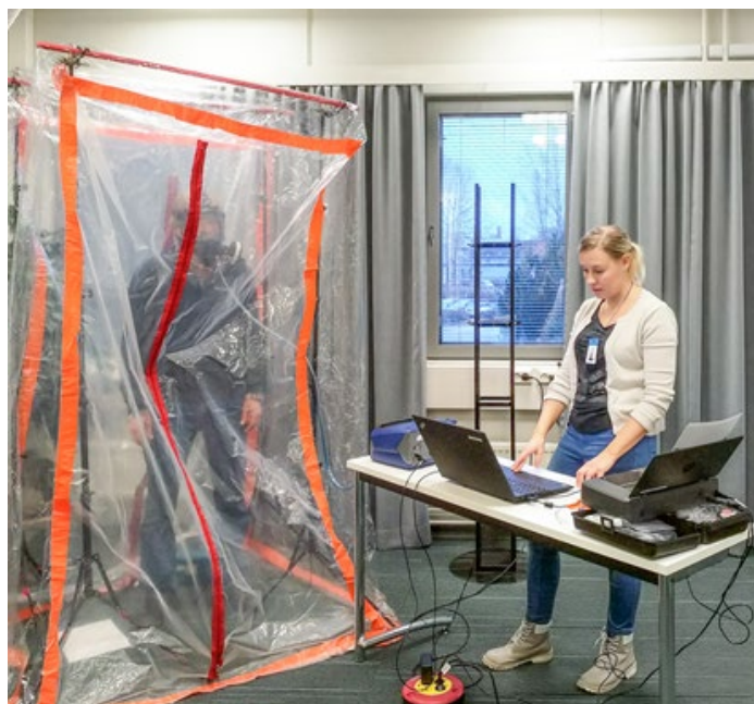
Kuva 17. Mittaustilanne tutkimuksen aikana. Mm. teltassa oleva hengityksensuojaimen käyttäjä, Porta-Count, PortaCountia ohjaava tietokone ja tulostin ovat näkyvillä.
