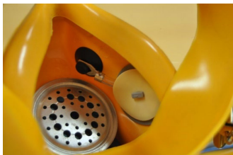
Näytteenottoletkun asennus sisänaamariin
