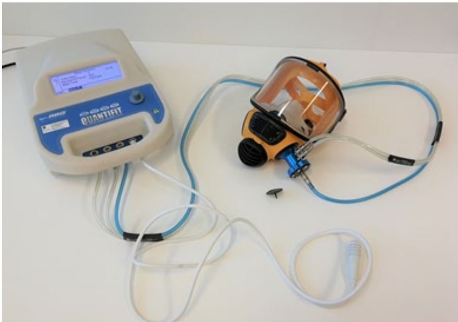
Kuva 15. Quantifit-laite, testiadapteri suojanaamarissa ja naamarin sisään-tuloventtiilin läppä.
