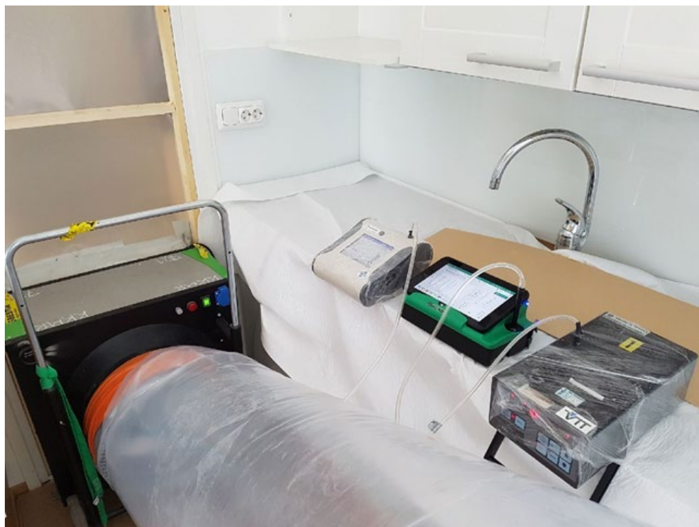
Kuva 21. Alipaineistajan erotusasteen ja vuotojen mittaus hiukkaslaskureilla.
