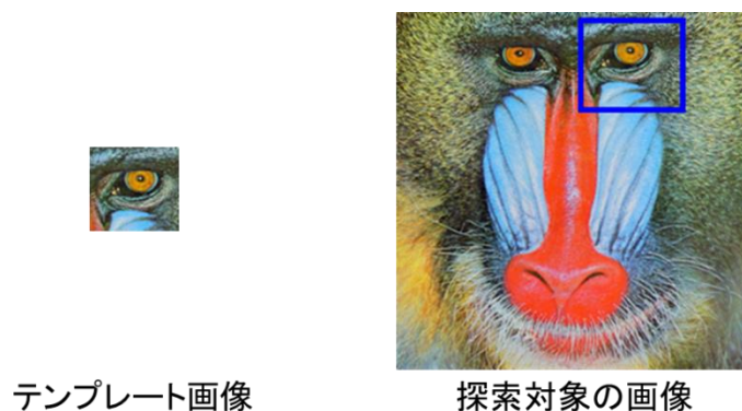
図 2.6 テンプレートマッチングの例
