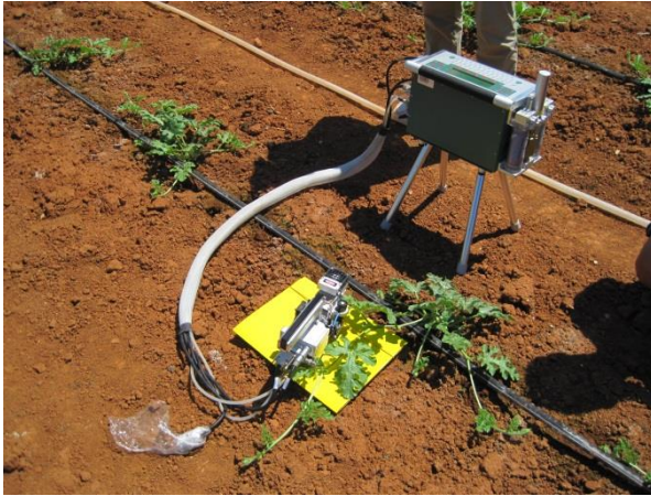
Slika 19. Mjerenje prijenosnim fotosintetskim uređajem LI-COR, 14. lipnja 2010.
