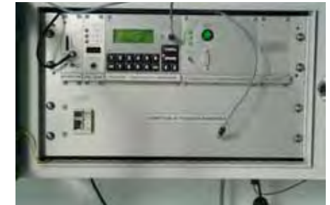
Compteur électronique ELFES-ELTA : boîtier électronique. © F. Travade EDF
