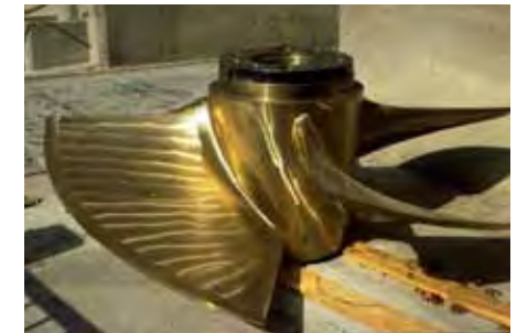
Hélice de turbine Kaplan à 3 pales - © M. Larinier
