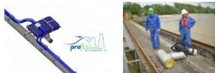
Répulseur ProFish supporté par un flotteur dans le canal d'amenée de l'usine de Biron (Schéma © ProFish, photo © F. Travade)
