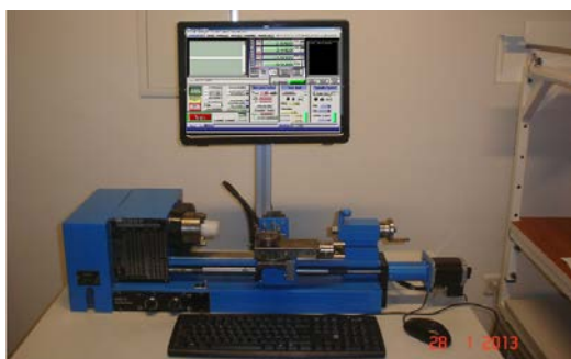
Slika 1. Rekonstrukcija tokarilice Hobbymat MD65 instalirane u laboratoriju za elektrostrojstvo [1]
