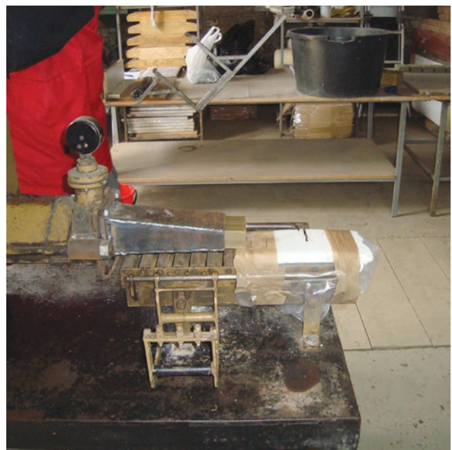
Slika 3. Strojna izrada opeka
