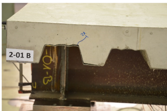
Abb. 4-36: Geringe Blechablösung zu Beginn des Versuchs (Serie 2-01, ca. 20 mm vertikale Verformung), aus [69]
