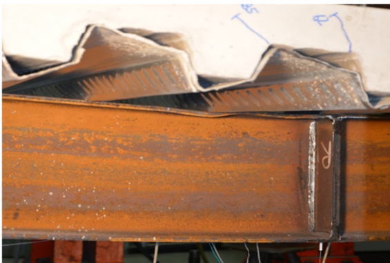
Abb. 4-44: Örtliches Ausbeulen des Oberflansches in Bereich der Lasteinleitung, aus [69]
