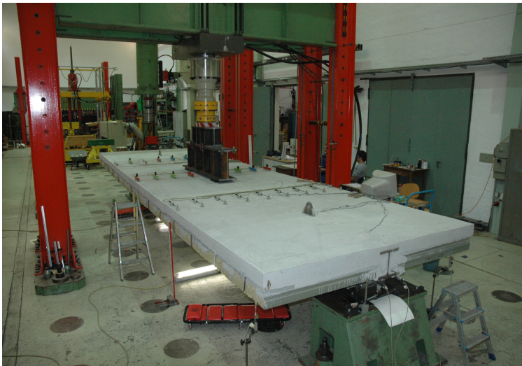
b) Trägerversuch aus CoSFB [72; 101]
