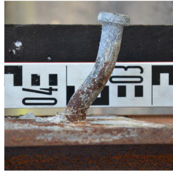
Abb. 4-17: Kopfbolzenverformung mit zwei Fließgelenken, aus [2]
