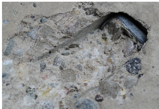
Abscheren des X-HVB am Übergang zwischen Trag- und Befestigungsschenkel Abb. 4-24: Hauptbestandteile des Mischversagens der Verbindungsmittel
