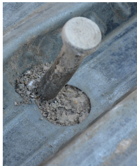
Abb. 6-7: Versagen des Profilblechs, Simulation Versuch 1-03
