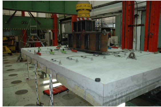
Abb. 4-51: Versuchsaufbau CoSFB Schubträger
