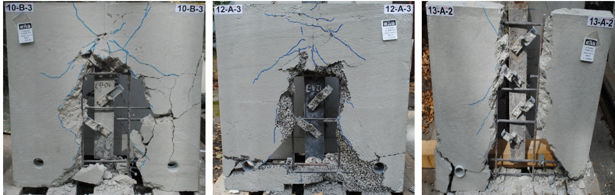
Abb. 4-22: Geöffnete Versuchskörper mit X-HVB 40 Schenkeldübeln
