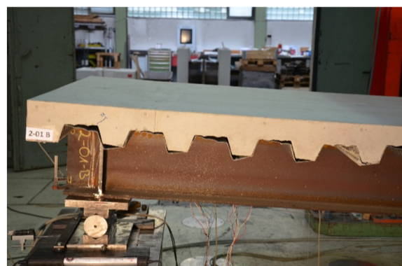
Abb. 4-37: Deutliche Blechablösung bei Versuchsende (Serie 2-01, ca. 130 mm vertikale Verformung), aus [69]
