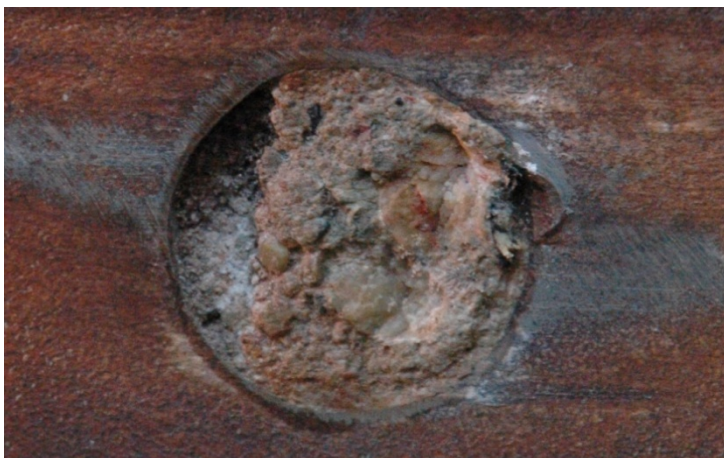
Abb. 4-30: Plastische Verformung einer Stegausehmunung des Probekörpers der Serie 2-1a, [73]
