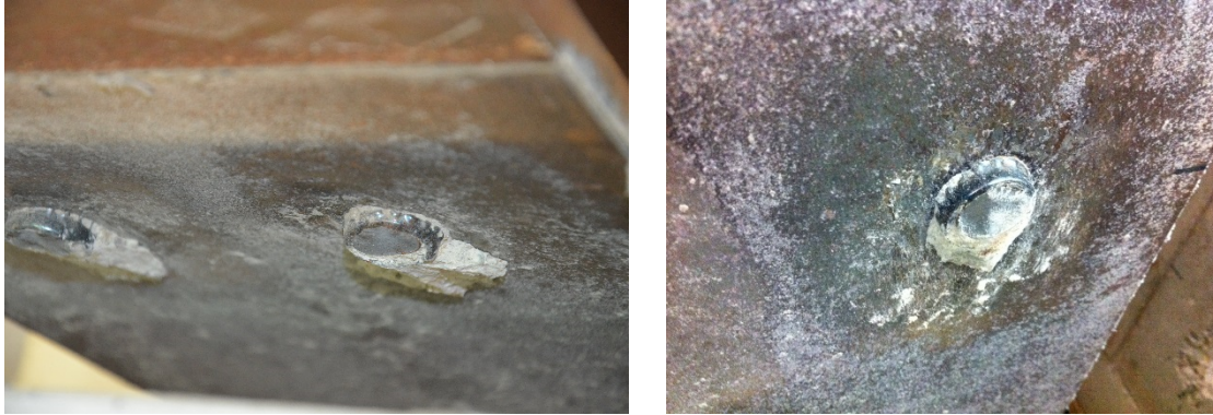
Abb. 4-7: Abscherversagen der Kopfbolzen, aus [2]
