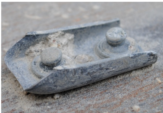
Abscheren des X-HVB am Übergang zwischen Trag- und Befestigungsschenkel Abb. 4-24: Hauptbestandteile des Mischversagens der Verbindungsmittel
