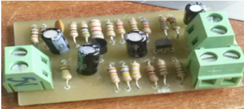
Figura 55 preamplificador montado en baqueta.
