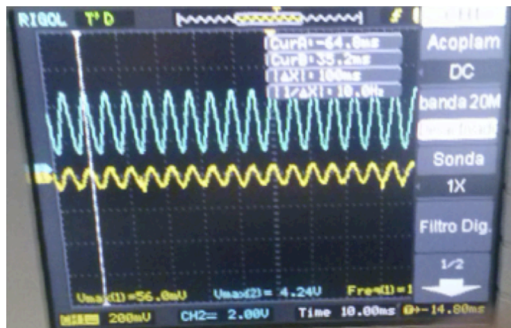
Figura 56 Entrada y salida del preamplificador mostrada por el osciloscopio.
