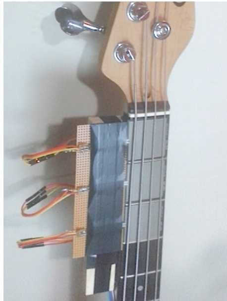
Figura 43 Arreglo de sensores en el mástil del bajo eléctrico.
