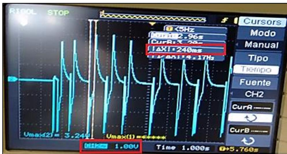
Tal como se aprecia en la Figura 35 el nivel incrementó en su señal de salida (3.24 V respecto a los 2.32 V anteriores), indicando que la escala del osciloscopio se mantuvo constante en 1 V. Por tal motivo se confirmaron los rangos planteados al tener entonces un máximo de voltaje entre 2.5 V – 3 V para ser trabajado posteriormente.
