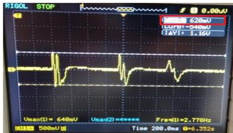
Tal como se esperaba, el comportamiento del sensor actuó apropiadamente respecto a su forma de trabajo y a la simulación desarrollada, debido a que al ser deformado alcanzó un máximo y mínimo de elasticidad para luego volver a su punto de equilibrio, a su vez se pudo determinar el valor máximo en voltios para el sensor (620 mV - Recuadro rojo de la Figura 31).
