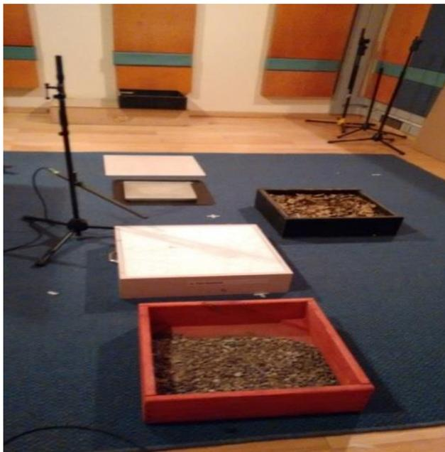
En la Figura 9 se pueden apreciar de arriba abajo las siguientes superficies: Madera, Concreto, Hojas/Tierra, Baldosa y Gravilla.
