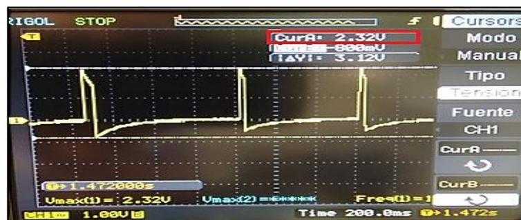
Visualizando la respuesta en voltaje respecto a su conexión directa, se puede apreciar una diferencia importante de 620 mV a 2.32 V (recuadro rojo de la Figura 33), cuestión que favorece su cometido, al obtener un nivel de trabajo apto para los pasos que vendrán a continuación dentro del proyecto.
