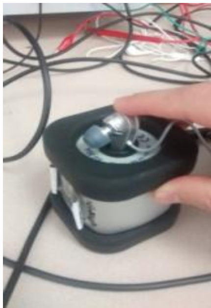
Figura 31. Medición de sensibilidad micrófonos con pistófono.
